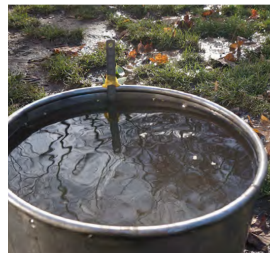
Infiltrationsversuch zur Bestimmung der Wasserdurchlässigkeit des Bodens.
