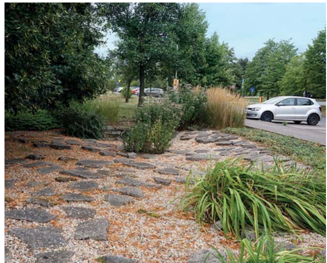
Bepflanzte Mulde zur offenen Wasserführung
